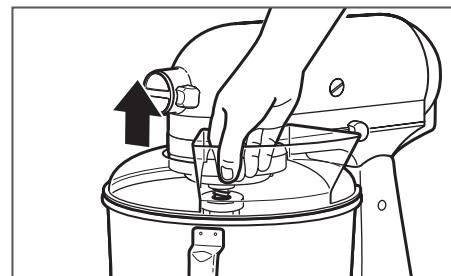
注入用カバーを持ち上げて、ボウルから外し、スタンドミキサーを正面に見て、手前にスライドさせるようにして引き出して取外してください。
