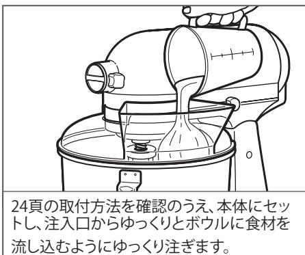
24頁の取付方法を確認のうえ、本体にセットし、注入口からゆっくりとボウルに食材を流し込むようにゆっくり注ぎます。
