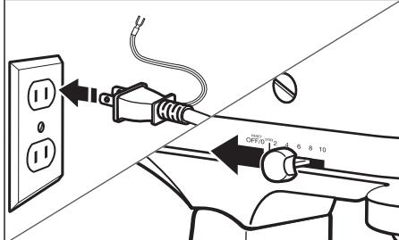
速度調節レバーが「0」となっていることを確認してから、電源プラグを専用コンセントに差し込んでください。
