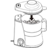
ワークボウルとカバー(パッキン)の間にすき間ができないよう、カバーは水平にしっかりと押しつけてセットします。
