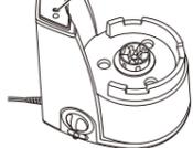
本体にワークボウルとカバーを正しくセットすると、本体上部にある動作スイッチがカバーによって押し込まれます。この状態で電源プラグをコンセントに差し込み、PUSH ボタンを押すと、運転が開始されます。
