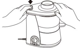
スタート時はカバーを片手でしっかりと押さえながら、もう片方の手でカバーの PUSH ボタンを押します。
