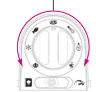
②運転切り替えスイッチで、スマートクックモード/スピードモードを切り替えます。
